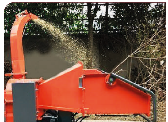
ALTURA DE DESCARGA 2000 mm
