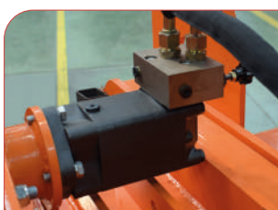
Motor hidráulico regulable del rodillo alimentador.
