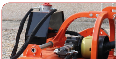
Sistema hidráulico: depósito + doble bomba
