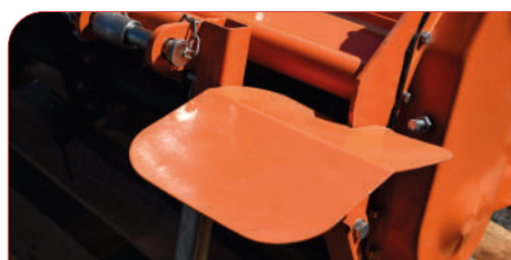
Alerón trasero de seguridad ajustable.
