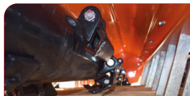
Martillos sobre eje de 168 mm.
