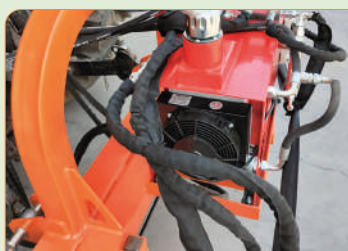
Radiador con termostato.
