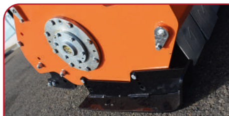
Refuerzo lateral del rotor. Ajuste de rodillo y patín.
