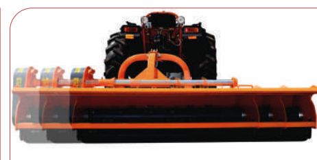
Desplazamiento horizontal de hasta 500 mm. Apertura ajustable
