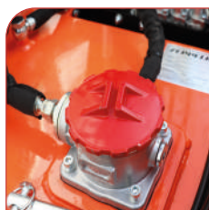
Depósito hidráulico 60L.
