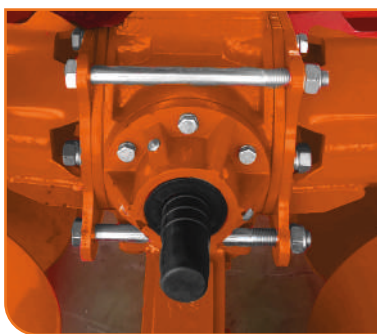
Grupo central de transmisión de potencia.
