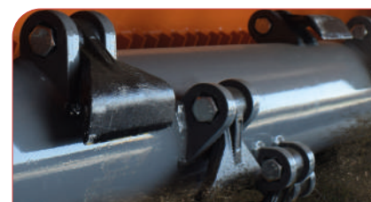
Martillos sobre eje de 168 mm.
