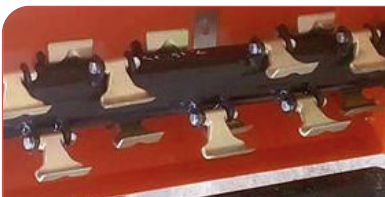
Martillos y eje de 170 mm.
