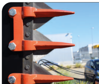
21 secciones dentadas y dobles dedos.
